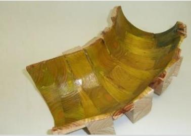
図 2-2-21 U字型で曲がった路 半円を切った残りの材を斜めに切ったものと組み合わせた路
