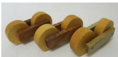
図 6-3-1 カヤ材の車輪、ケヤキ材の車輪を繋ぐ部品はケヤキ (左・中)・ホオ (右)
