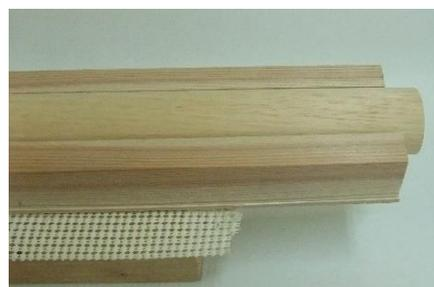
図 1-1-3 枠に丸棒を入れて切る
