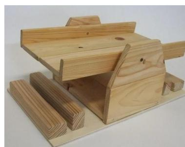
図 2-3-6 ベニア板にシーソーの路と板①・②を固定する
