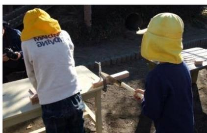
図 7-1-1 クランプで固定して切る
