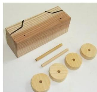
図 1-2-4 角材に型紙を使って印をつける
