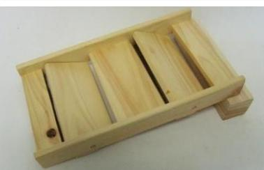
図 2-2-17 揺れる路 板の傾きが分かるよう路面右側下に角材を置いている
