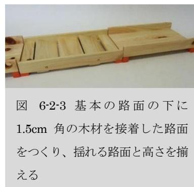
図 6-2-3 基本の路面の下に 1.5cm 角の木材を接着した路面をつくり、揺れる路面と高さを揃える
