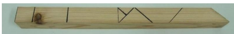
図1-1 ツリーの積み木の切り線 水性ペンで線の太さが2mmになるように型紙を使って印をつける
